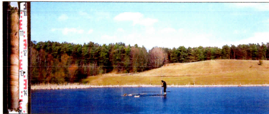
Bohrkern zwischen 7,0 und 7,5 m unter der Eisoberkante, geschichtete Seeablagerungen | Foto: N. Schlaak daneben: Seebohrung vom Eis des Bültenpfuhls, Februar 2014 | Foto: M. Schlaak
